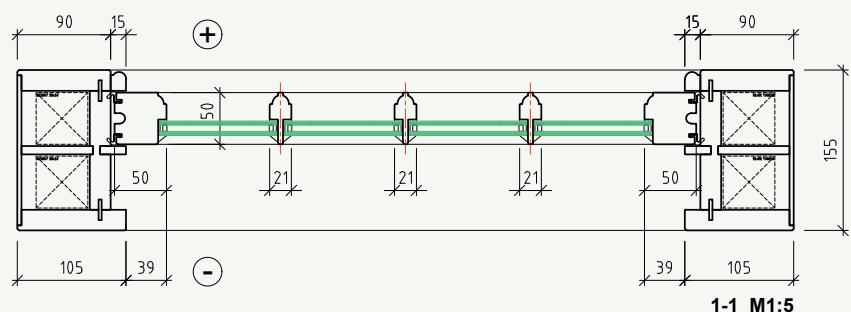
SLIDING SASH 50 cord & pulley PUTTY GLAZING WINDOW
