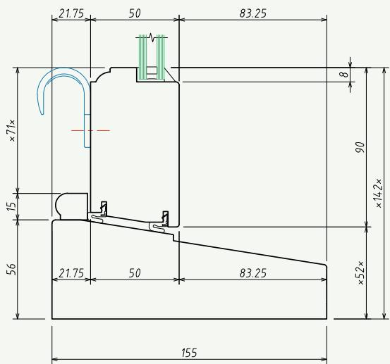
SLIDING SASH 50 cord & pulley PUTTY GLAZING WINDOW
