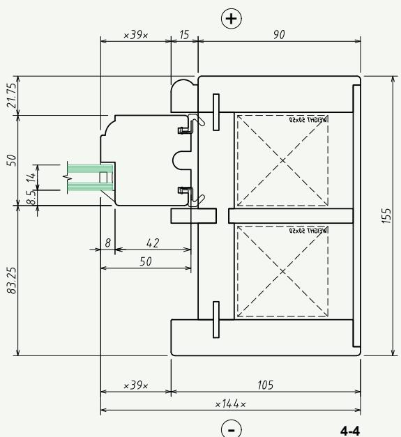
SLIDING SASH 50 cord & pulley PUTTY GLAZING WINDOW
