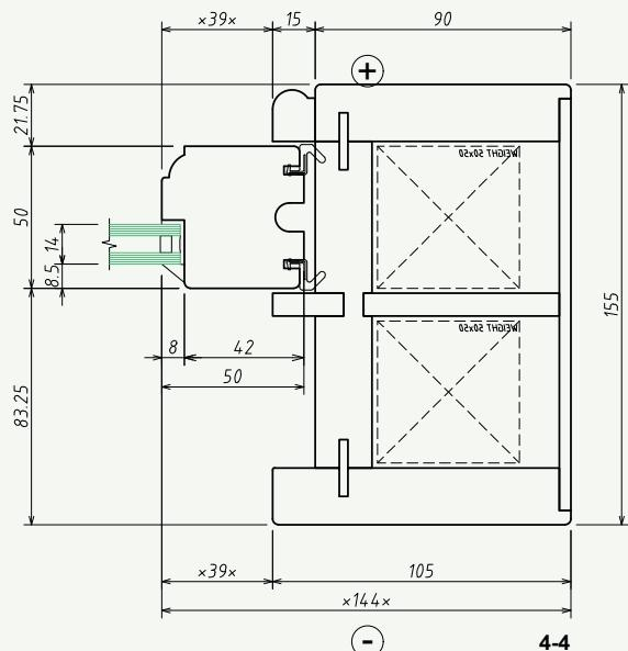
SLIDING SASH 50 cord & pulley PUTTY GLAZING WINDOW
